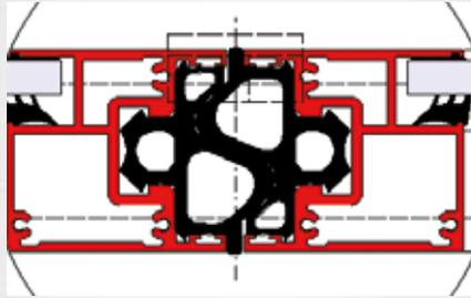
Mitteldichtung in Labyrinthform und aus Hartmaterial
